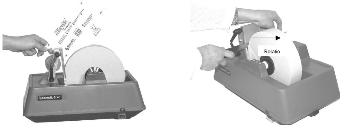
**OBS!** Før slibning påbegyndes, sikres det, at stenens omløbsretning er korrekt (fig. 2). Vigtigt at stenen løber væk fra en, når man står bag ved maskinen.
